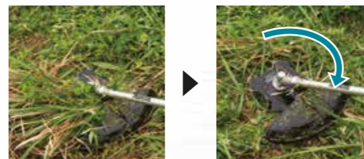
Đảo chiều để làm sạch cỏ vướng trong lưỡi cắt
