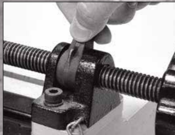
Khóa kẹp tháo nhanh dùng để tháo lắp vật liệu cắt nhanh
