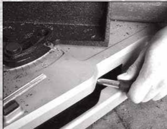
Điều chỉnh góc cắt từ 0° - 45°
